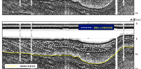
図4 潮流口横断測線の反射記録断面中に確認される傾斜内部反射面
